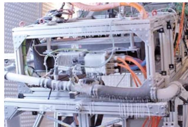
Teste do sistema de célula a combustível na câmara climática com inclinação.
