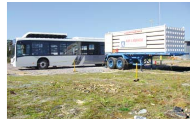
Estação de Abastecimento utilizado nos testes do veículo em terreno próximo a Tutto, demonstrando a simplicidade do procedimento de abastecimento e a baixa periculosidade que é comparável aos cuidados dos demais combustíveis utilizados comumente.
