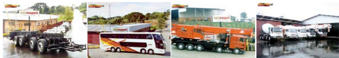
Transformação dos chassis convencionais de ônibus e caminhões para instalação do segundo eixo dianteiro dirigível, realizadas a partir de 1994
