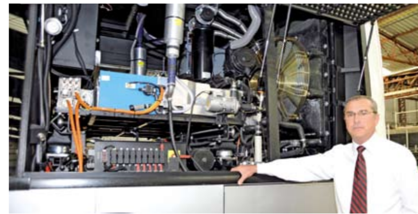
A foto mostra todos os componentes do sistema de propulsão à célula a combustível a hidrogênio, que utiliza dois sistemas de célula a combustível da linha automotiva - primeiro do mundo -, desmistificando e simplificando todo o processo para torná-lo viável técnico e economicamente a nível mundial. Agenor Boff – Diretor da TuttoTrasporti
