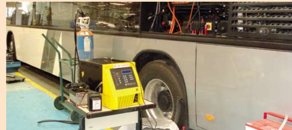
Testes de vazamento com hélio para certificação das instalações.
