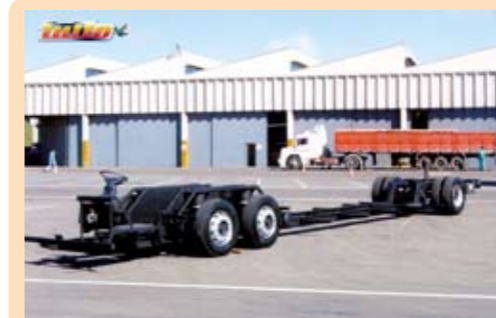
Chassi Tutto 15m, piso baixo total com segundo eixo dianteiro dirigível para utilização de trações híbridas que utilizam combustíveis renováveis (álcool, GNV, biodiesel e hidrogênio)
