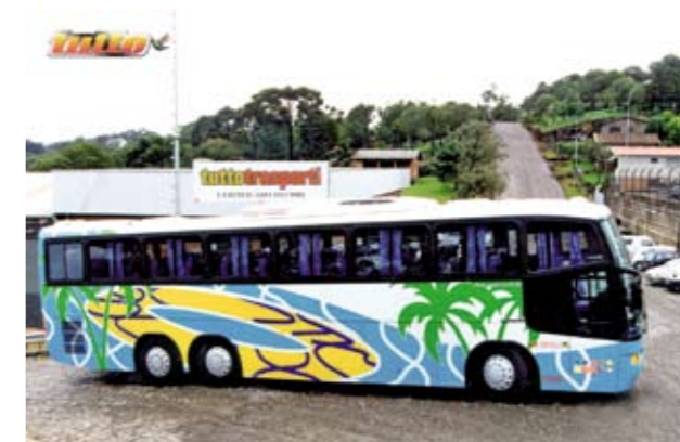
Chassi Plataforma com 3º eixo e ar condicionado produzidos pela Tuttotrasporti em 1995
