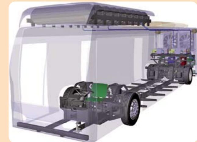
Chassi Tutto 12m com sistema de propulsão integrado
